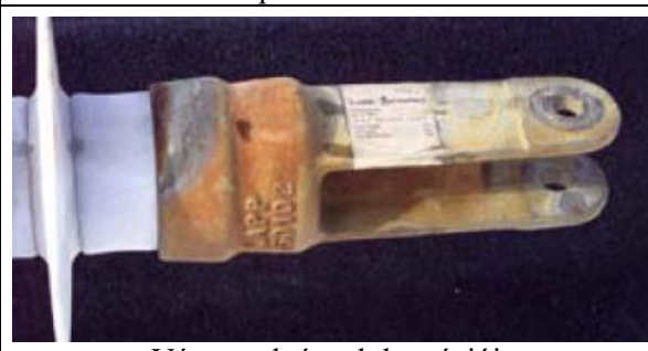
Vég szerelvények korróziója
